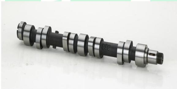
Es un eje acoplado al cigüeñal por medio de engranajes o cadenas, que gira a la mitad de velocidad que aquél. Longitudinalmente se disponen unas excentricidades o salientes asimétricos, en número de uno por cada válvula; por lo tanto, dos por cilindro y ocho en el caso de un motor de cuatro cilindros.
